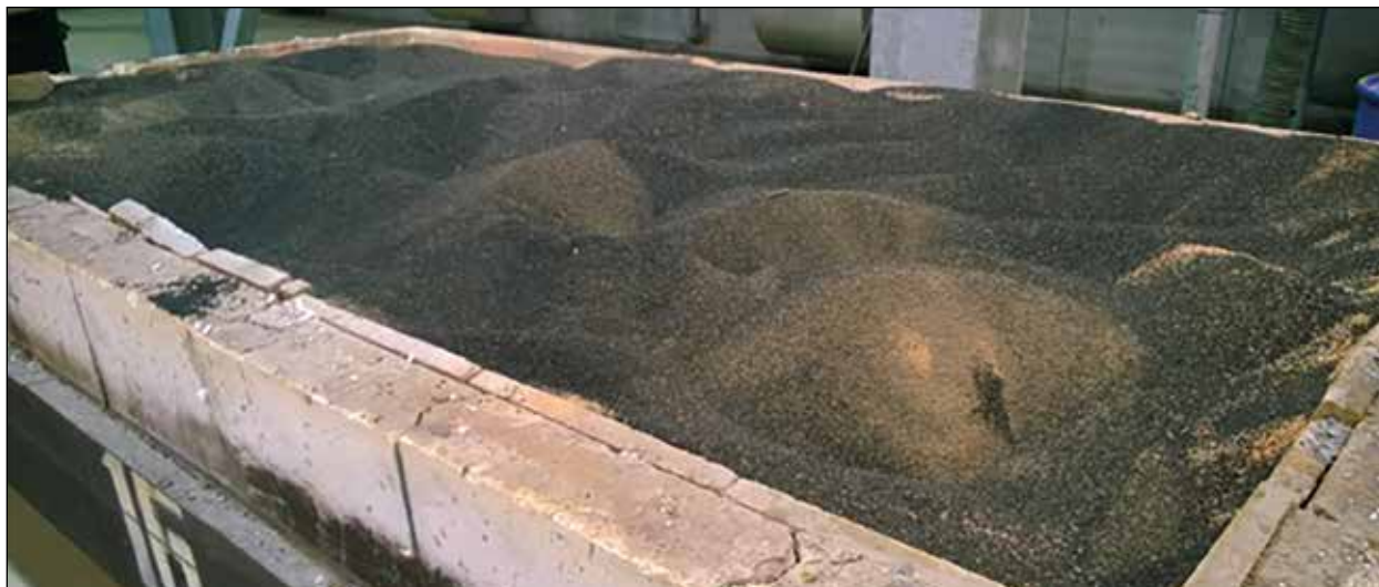
Рисунок 5 – Подовая тележка, заполненная отработанным активированным углем (ноябрь 2017 г., фотография автора)
