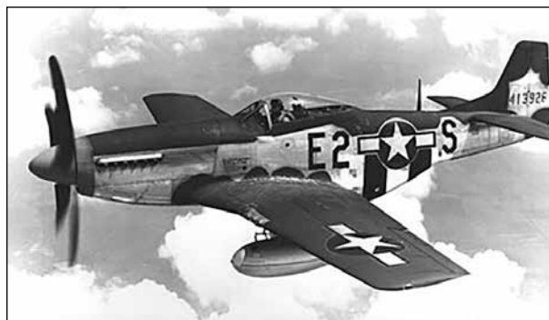
Рисунок 6 – F-51 «Мустанг» – американский одноместный истребитель дальнего радиуса действия периода Второй Мировой и Корейской войн. Практическая дальность: 1520 км; крейсерская скорость: 580 км/ч. Мог нести под крылом две бомбы массой до 454 кг. В феврале 1952 г. на четырех из них было установлено оборудование для диспергирования сухих бактериальных рецептур и насекомых. Распыление рецептур бактерий производилось с высоты ~150–300 м при скорости самолета 560 км/ч. При распространении насекомых скорость снижалась до 320 км/ч [3]. Фотография из https://en.wikipedia.org/wiki/North_American_P-51_Mustang (дата обращения: 20.11.2020)
