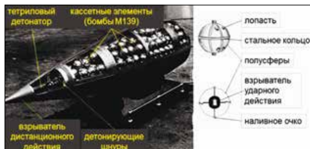
Рисунок 10 – Устройство химической боевой части и кассетного элемента ракет [3, 10, 11]
