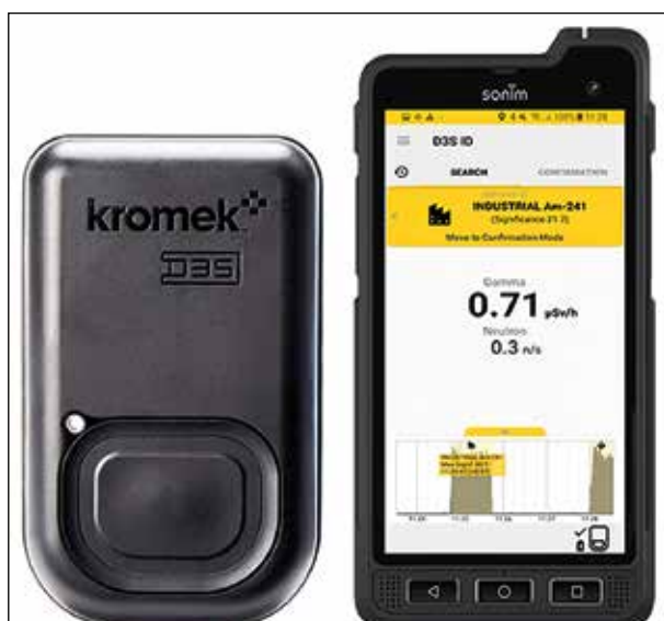
Рисунок 4 – Общий вид прибора серии D3S и отображение на экране мобильного телефона результата его работы (фото с сайта http://www.kromek.com/products/ (дата обращения: 10.09.2020))
